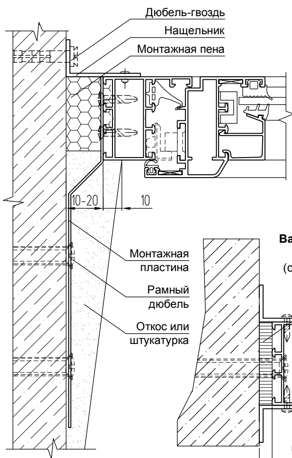
Вариант монтажа с помощью монтажных пластин
