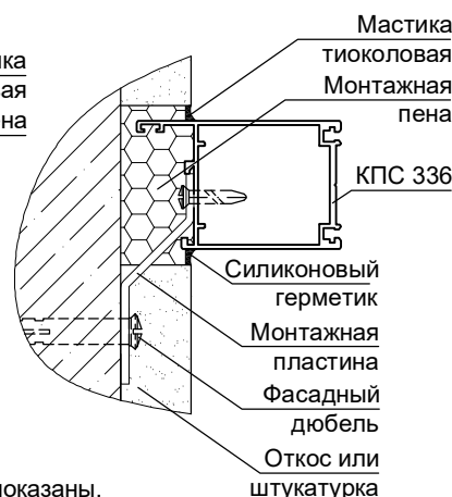
Вариант монтажа двери с помощью монтажных пластин
